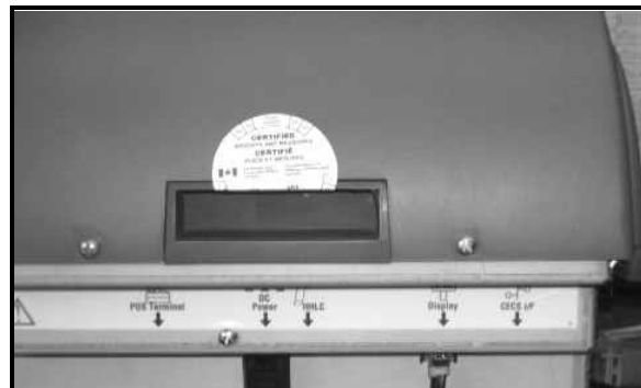
Back Housing Seal / sceau arrière au boîtier
