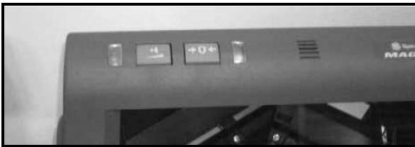
Speaker & Zero controls/contrôle du volume et le centre du zéro
