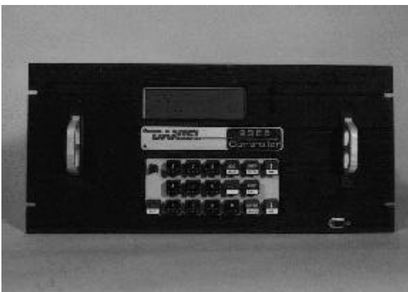
Figures 4-5: 2350 Controller with Keypad and Display (left) and without keypad and display (right) / 2350 contrôleur avec un clavier et un dispositif (à gauche) et sans un clavier et un dispositif (à droite)
