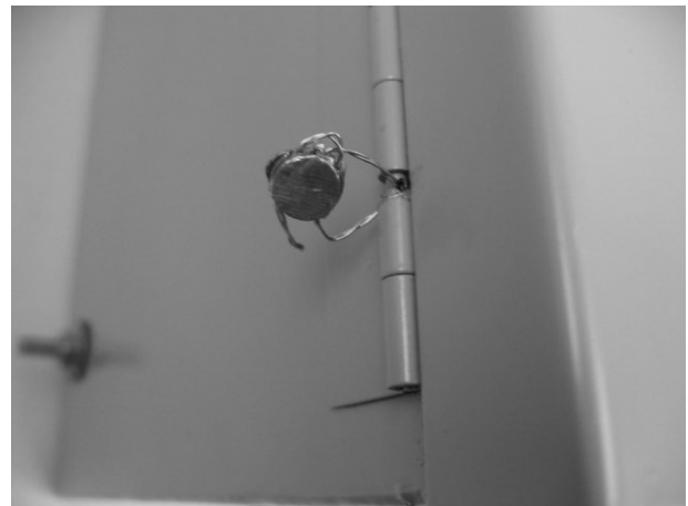
Fig. 5: Sealing of 1140L hinge / Scellage de la charnière du modèle 1140L
