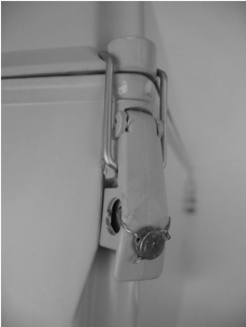
Fig. 2: Sealing of 1140C latch / Scellage du loquet du modèle 1140C
