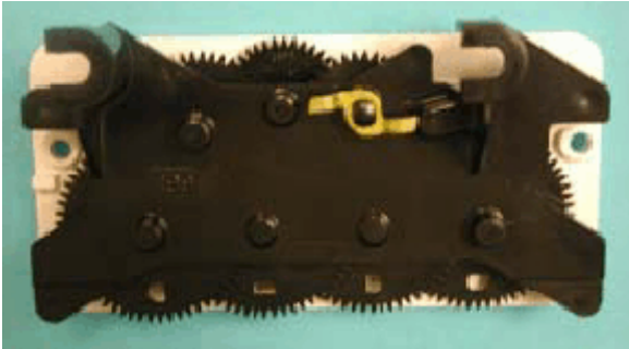
Figure 1. Index with old dog / Indicateur avec l'ancien organe d'entraînement
