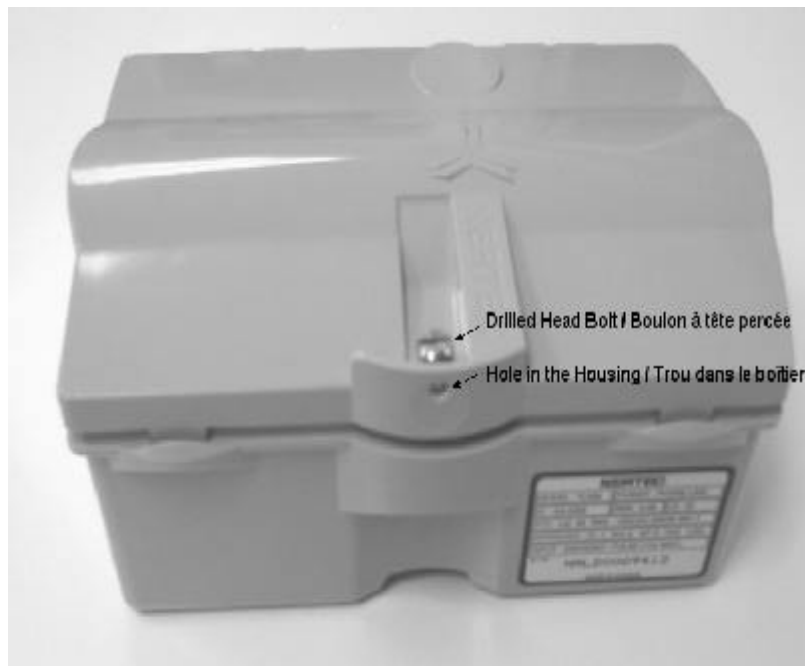
Sealing arrangement for the new housing / Mode de scellage du nouveau boîtier
