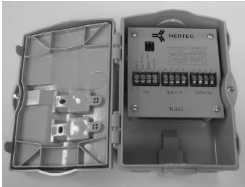
TL402 inside the new housing / TL402 à l'intérieur du nouveau boîtier
