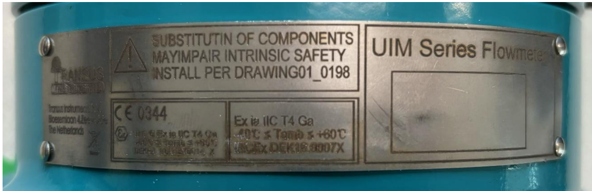
Figure 3: SPU Marking Plate Example / Exemple de plaque de marquage de unité de traitement du signal
