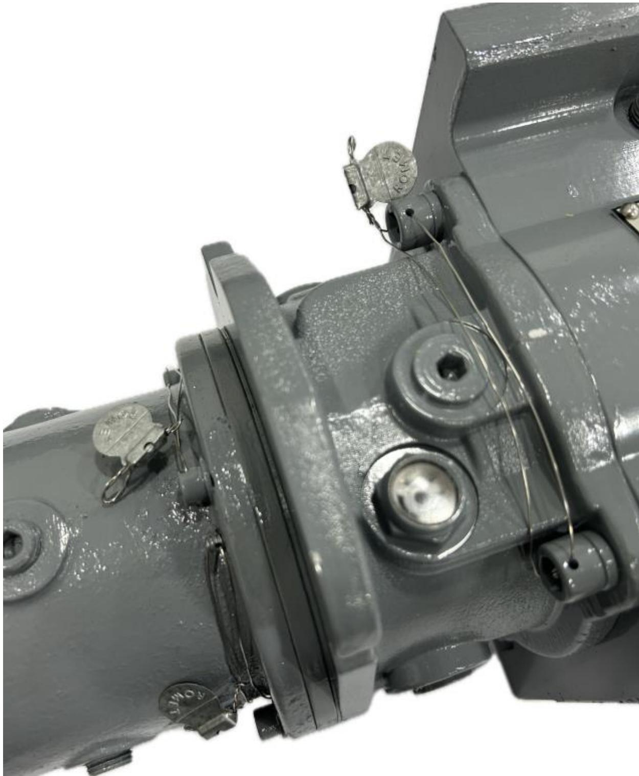
**Figure 8: Conventional Sealing of Meter Body with STD CTR/STDID/DCID Module (Non-integral) / Scellage conventionnel du corps du compteur avec le module STD CTR/STDID/DCID (non-intégré)**
