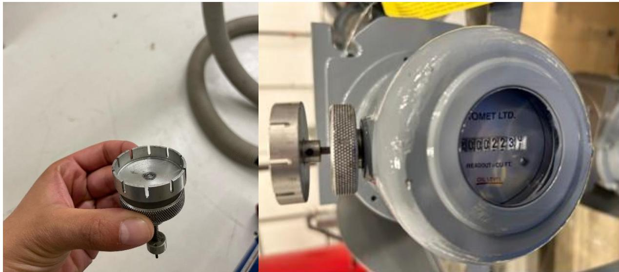
Figure 1: Slotted disk adapter / l'Adaptateur de disque à fentes
