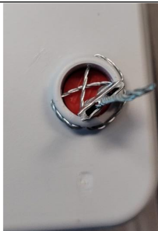
Figure 5: Closer view of the X shape conventional sealing and plug seals / Vue rapprochée de la forme en X des joints d'étanchéité conventionnels et des joints à bouchon
