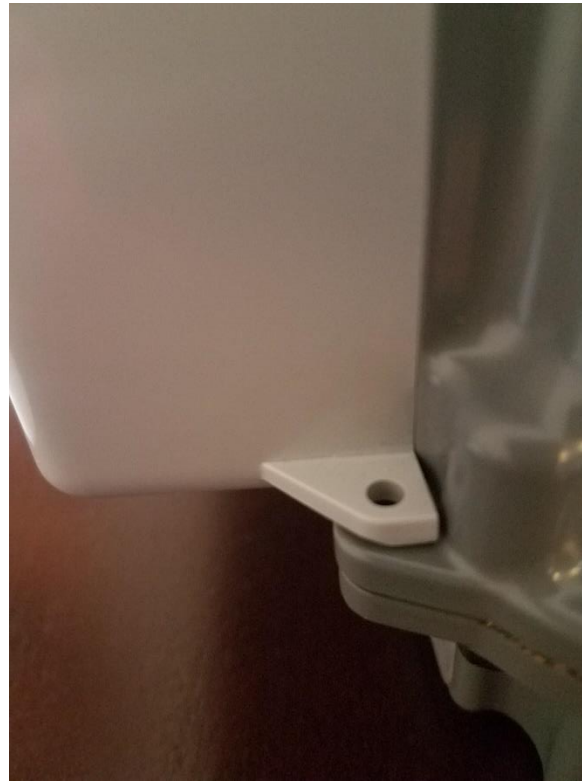
Figure 1 : Sealing location on sides of meter case and index / Emplacement des scellés sur les côtés du boîtier du compteur et de l'index
