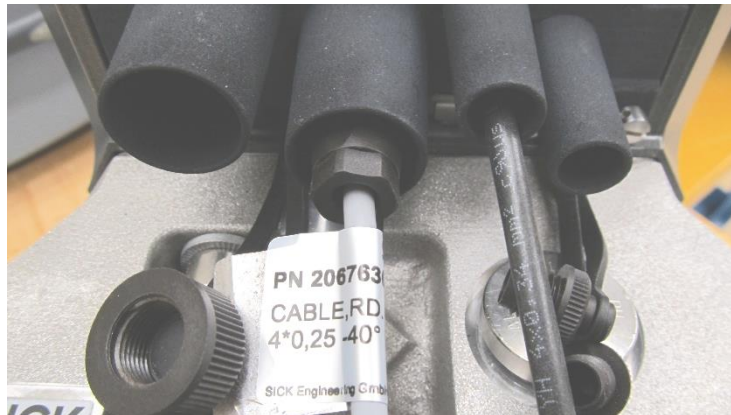
Figure 10 – I/O connectors and permanent sealing cover / connecteurs E/S et couvercle de scellage permanente
