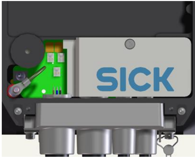
Figure 12 - Termination board and permanent and configurable connector sealing provisions / Dispositions du sceau de sécurité pour plaque de terminaison et connecteurs permanents et configurables
