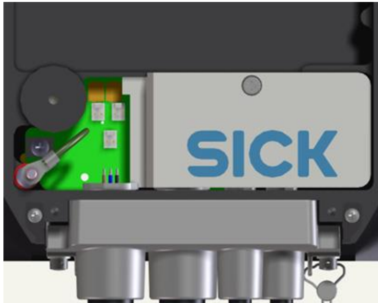
Figure 11 - Termination board and connector sealing provisions / Dispositions du sceau de sécurité pour plaque de terminaison et connecteurs
