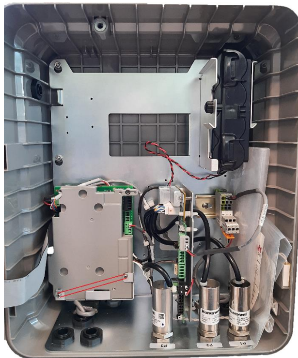
Figure 6. I/O board sealing plate inside MIWI 350 (Sealing method indicated with red lines) / Plaque de scellement de la carte E/S à l'intérieur du MIWI 350 (méthode de scellement indiquée par des lignes rouges)
