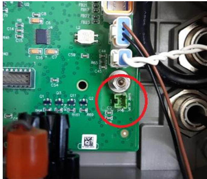
Figure 8. Location of Metrological Jumper, bottom right corner of I/O board / Emplacement du cavalier métrologique dans le coin inférieur droit de la carte E/S
