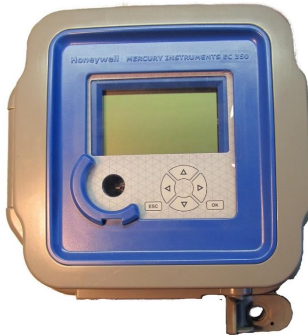
Figure 3. External view of EC 350 (Sealing Hasp Lower Right) / Vue extérieure du EC 350 (Moraillon de scellement en bas à droite)
