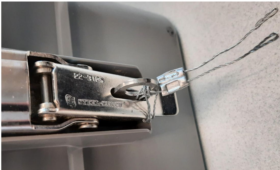
Figure 4. MIWI 350 Case Sealing Method / MIWI 350 méthode de scellement des boîtiers
