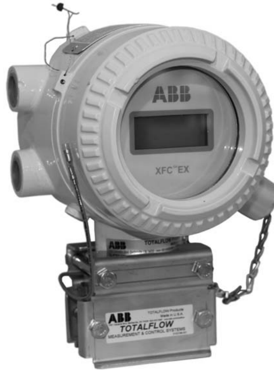
Figure 9: Sealing of Enclosure of XFC G4 EX flow computer / Scellage du boîtier du débitmètre ordinateur XFC G4 EX
