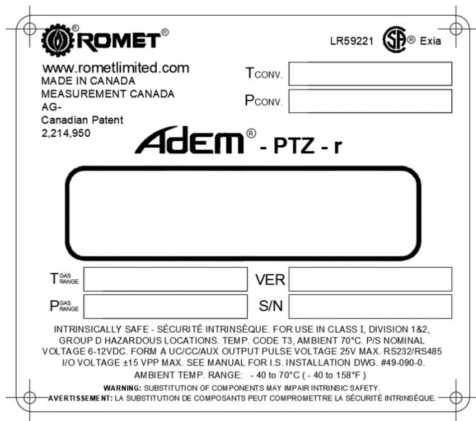
**Figure 11:** AdEM-PTZ-r nameplate – used for imperial and metric configuration. / Plaque signalétique de l'AdEM-PTZ-r – pour configurations imperial et métrique.
