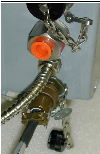
Figure / Image 3 : Sealing of the output pulse cannon connector Scellage du connecteur canon de sortie d'impulsion
