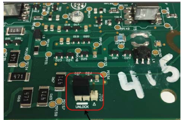
Figure 3. Pin and jumper arrangement to unlock the EEPROM / L'arrangement de la broche de connexions pour déverrouiller le EEPROM
