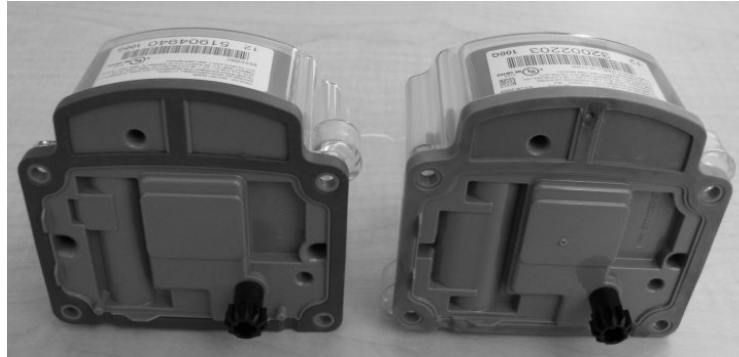
Fig. 19: 100G ERT, Part No. ERG-5000-002 and 100G Datalogging ERT, Part No. ERG-5002-002 (Rear View)/ 100G ERT, No de pièce ERG-5000-002 et 100G Datalogging ERT, No de pièce ERG-5002-002 (vue arrière)
