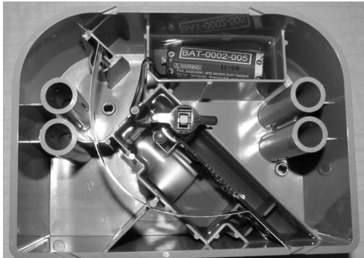
Fig. 23: 100G Datalogging ERT, Part No. ERG-5002-008 (Front View) / N° de pièce ERG-5002-008 (vue de face)
