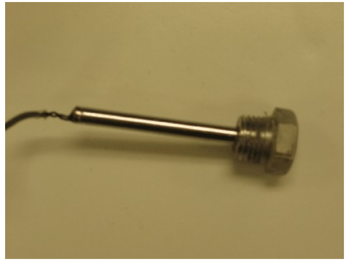
Figure 2. Thermistor probe un-threaded from the meter body / Sonde à thermistance non fileté au corps du compteur.
