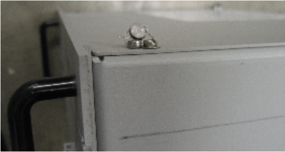
Figure 9 Sealing provision for rackmount enclosure / disposition de scellage pour le boîtier sur bâti
