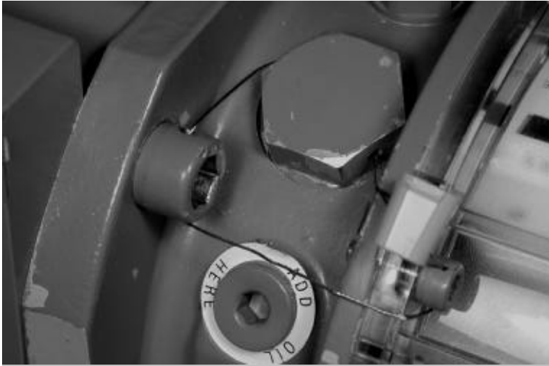
Photo 4: Sealing of the CMTC module to RPM series meter/ Scellage du module CMTC au compteur de la série RPM
