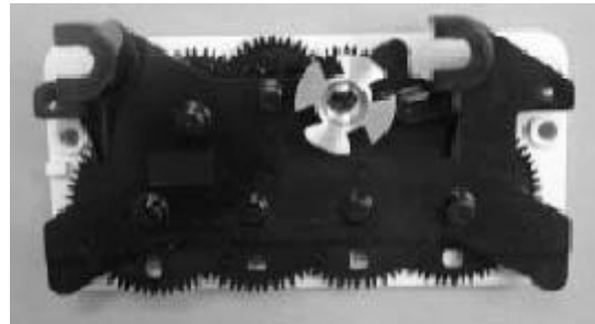
Fig. 6 : Index with new dog / indicateur avec nouvel organe d'entraînement
