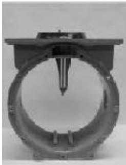
Fig. 5 : Index with old dog / indicateur avec ancien organe d'entraînement
