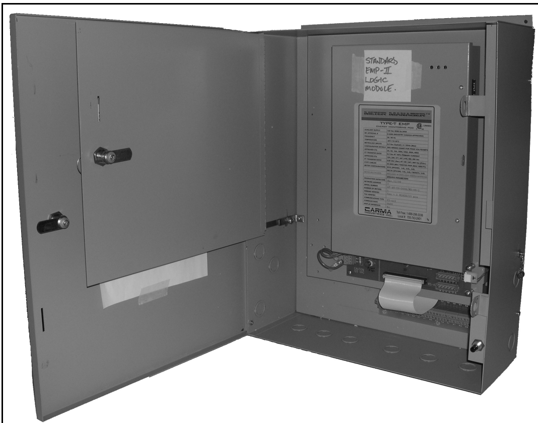
Rev. 13, The EMP-II logic module interfaced with the EMP-I enclosure. Rév. 13, Le module logique de MSÉ-II avec interface du boîtier de MSÉ-I.
