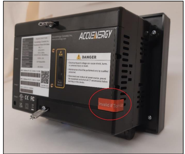
Tamperproof sticker on the meter nameplate. / Autocollant d'inviolabilité sur la plaque signalétique du compteur.
