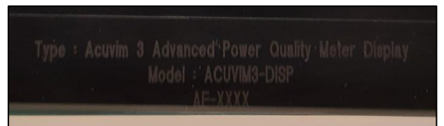
Display module nameplate. Located on the top of the module. / Plaque signalétique du module d'affichage. Située sur le dessus du module.
