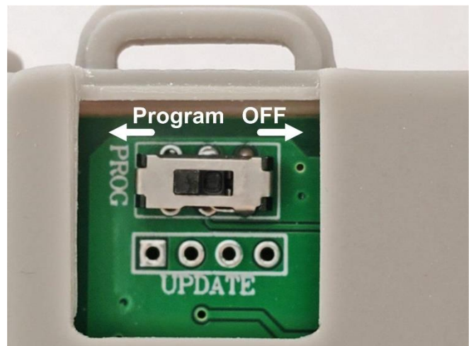
Meter module programming switch / Interrupteur de programmation du module de mesure
