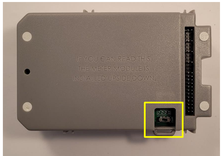
MCP-600MA meter module programming switch located on the underside of the meter module. / Commutateur de programmation du module de mesure MCP-600MA situé sur la face inférieure du module de mesure.
