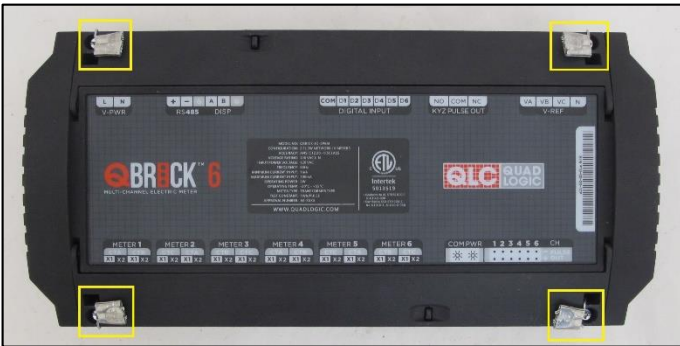
Figure 2 – 4 installation seals on the metering module's terminal covers. / 4 sceaux d'installation sur les couvercles des terminaux du module de mesure.
