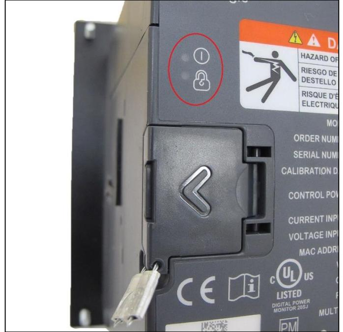
Sealed programming switch door below power and programming switch LEDs. / Porte de l'interrupteur de programmation scellée sous les DEL de marche et d'interrupteur de programmation.
