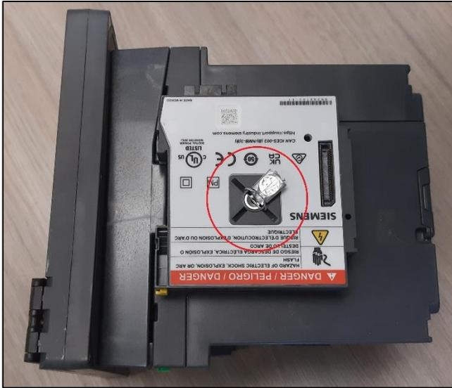
Additional seal required when the meter is equipped with one of the optional communication cards. / Sceau supplémentaire requis lorsque le compteur est équipé d'une des cartes de communication optionnelles.
