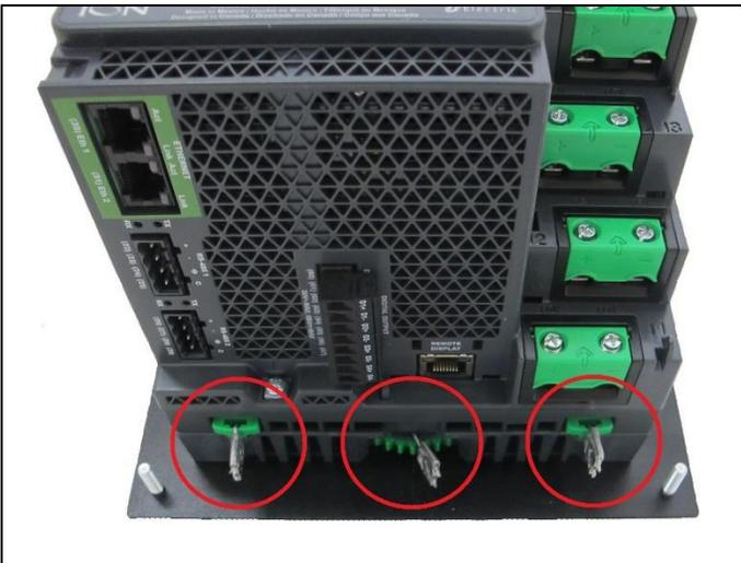
The underside of the meter with the three metrological seals required to prevent separation of the various modules. / La face inférieure du compteur avec les trois sceaux métrologiques nécessaires pour éviter la séparation des différents modules.
