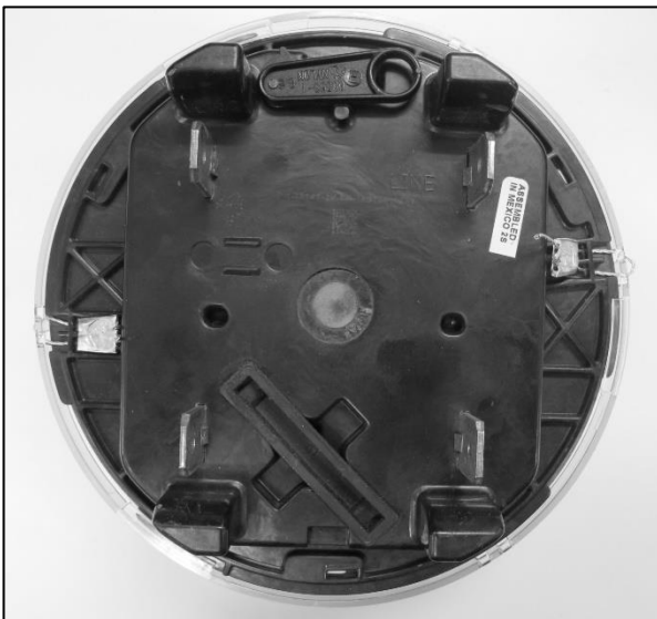
Meter Sealing / Scellage du compteur
