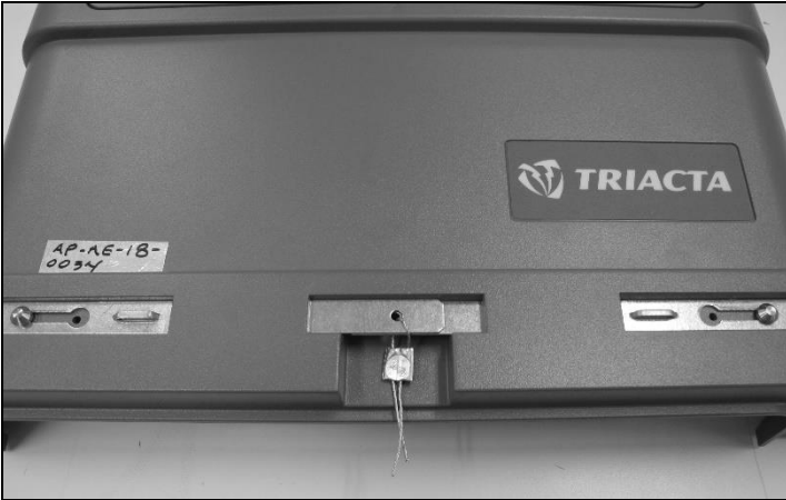
Utility seal used with exposed terminal card / Sceau de service public avec la carte bornes exposée
