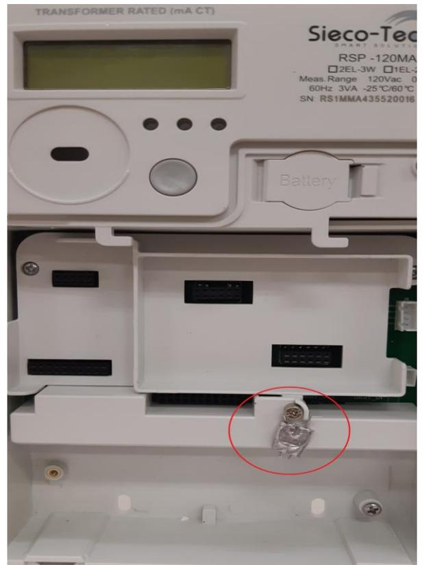
Meter terminals seal / Le sceau pour les bornes du compteur
