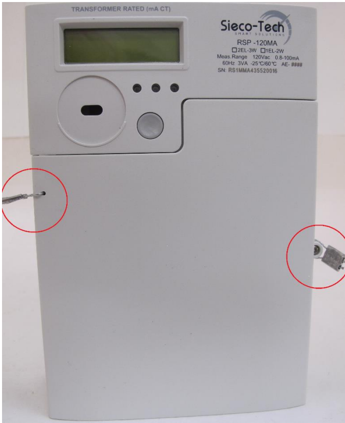
Two utility seals / Deux sceaux d'installation
