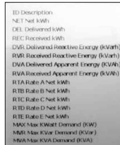
Display Legend for E650 S4x RXR meter / Légende d'affichage pour le compteur E650 S4x RXR
