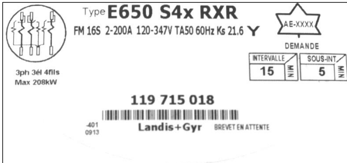
E650 S4x RXR polyphase meter nameplate / Plaque signalétique du compteur polyphasé E650 S4x RXR
