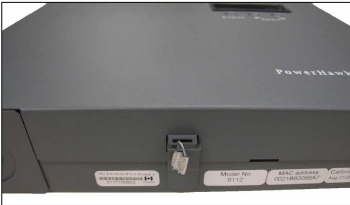
**Installation Sealing Location / Emplacement du sceau d'installation**
