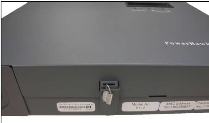
Installation Sealing Location / Emplacement du sceau d'installation
