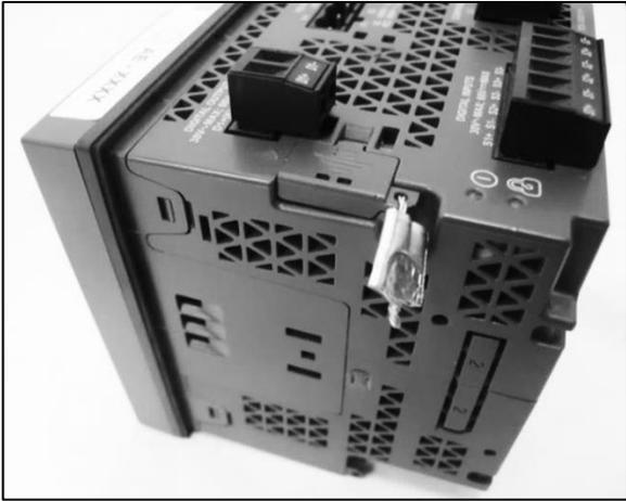
Sealed meter / Compteur scellé
