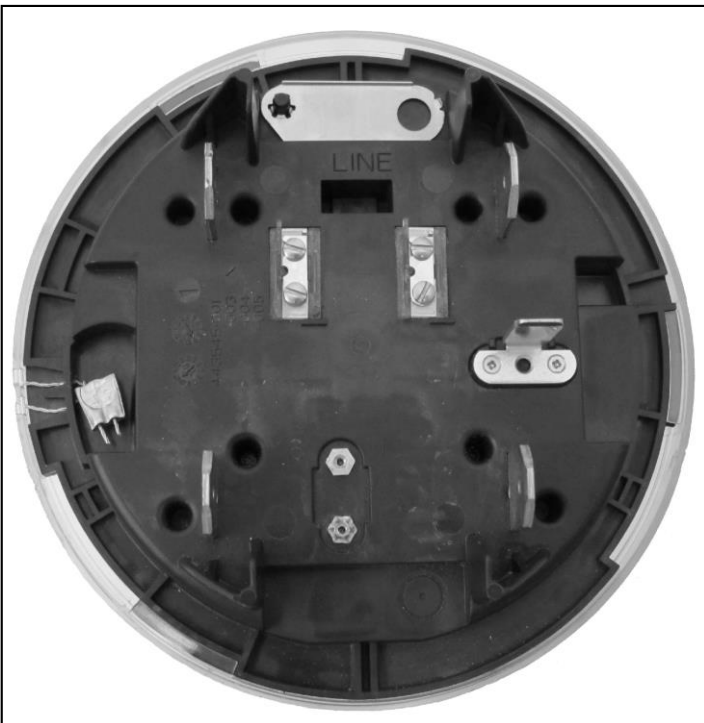
Sealed CENTRON II OpenWay shown with revised plugs equipped with test links / CENTRON II OpenWay scellé, montré avec les bouchons révisés qui sont équipés de barrettes conducteurs d'essai
