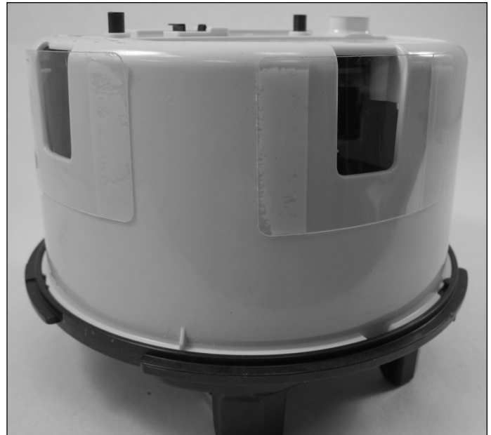
Polycarbonate shields placed over the three meter housing access holes / Boucliers en polycarbonate placés sur les trois trous d'accès du boîtier du compteur
