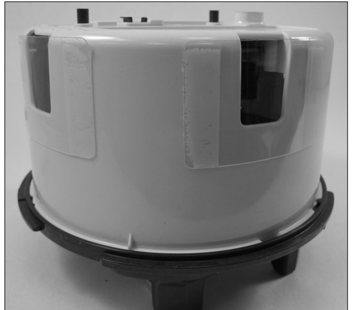
Polycarbonate shields placed over the three meter housing access holes / Boucliers en polycarbonate placés sur les trois trous d'accès du boîtier du compteur
