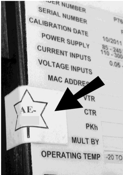
Tamper evident sticker used to attach meter Sub-Labels to ION8650 meters and meter enclosures. / Une exemple d'un autocollant inaltérable utilisé pour attacher les plaques signalétiques supplémentaires à les compteurs et leurs boîtiers.
