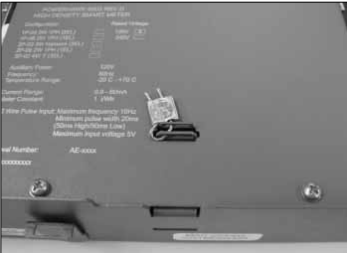
Meter Sealing / Scellage du compteur
