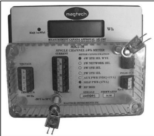
Utility seals for meter with transparent terminal cover / Sceaux de service public pour le compteur avec couvre-bornes transparent (2)
