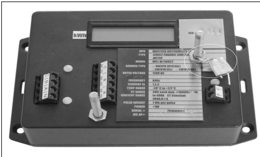
Metrology seals under the terminal cover / Sceau de métrologie sous le couvercle des bornes (1)
