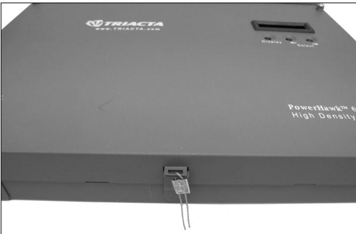
Utility Sealing Location / Emplacement du sceau d'utilité
