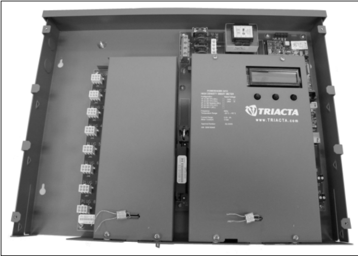
Metrological Sealing Locations / Emplacements des sceaux métrologiques
