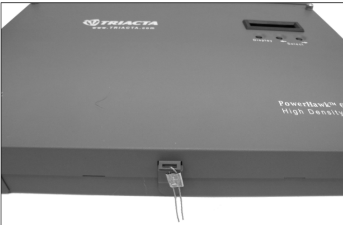
Utility Sealing Location / Emplacement du sceau d'utilité
