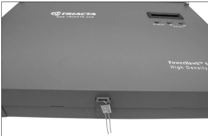
Utility Sealing Location / Emplacement du sceau d'utilité
