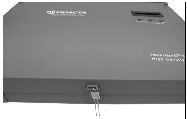
Utility Sealing Location / Emplacement du sceau d'utilité
