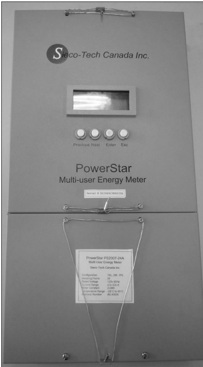
Sealing for the PowerStar meter / Scellage pour le compteur PowerStar
