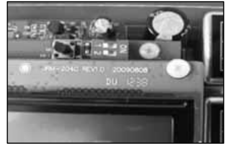
Software Programming Switch / L'interrupteur de programmation du compteur
