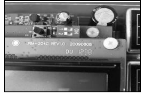
Software Programming Switch / L'interrupteur de programmation du compteur
