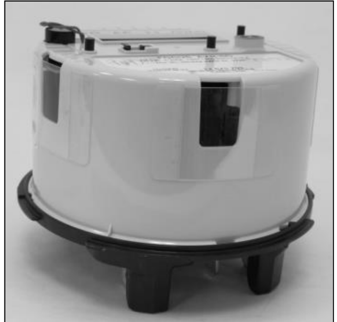
Polycarbonate shields placed over the three meter housing access holes / Les boucliers en polycarbonate placés sur les trois trous d'accès du boîtier du compteur
